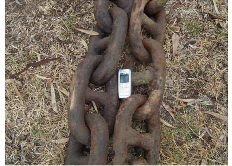
Se puede modificar la cadena soldándole cada 50 cm barras de aceros perpendiculares a la línea, y en la parte central de la cadena se le coloca contrapesos esféricos de 500 kg para evitar que la cadena ruede levantándose mucho y pase sobre los árboles.
